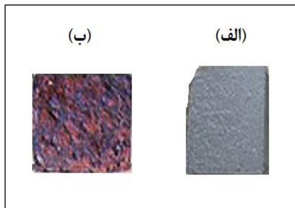
شکل ۹- نمونه یک‌بار پوشش داده شده: (الف) پیش از آزمایش، (ب) پس از آزمایش ۶۰ ساعت نگهداری
