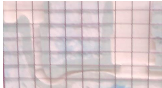
شکل ۳- قالب با یک وجه شفاف با پوشش شیشه و توری فلزی استفاده شده در این پژوهش.
