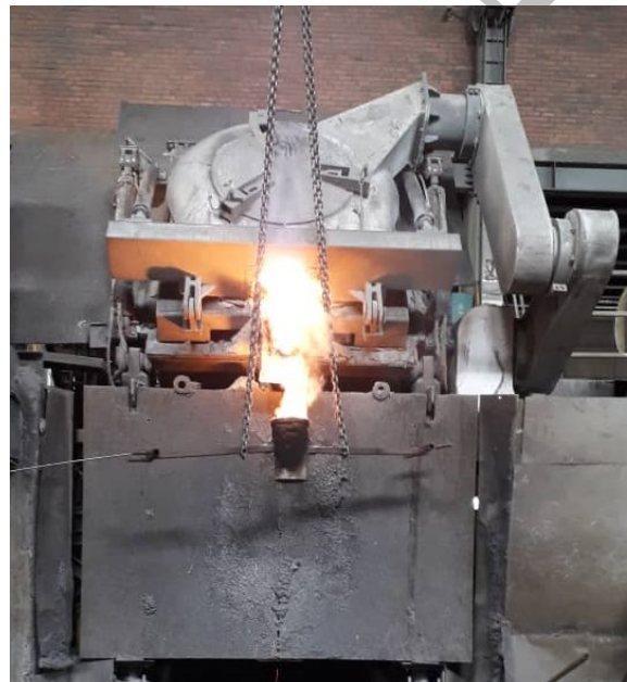
شکل ۳- الف) کوره القایی ۶ تنی جهت آماده‌سازی ذوب، ب) قالب‌های آماده شده جهت ذوب‌ریزی
