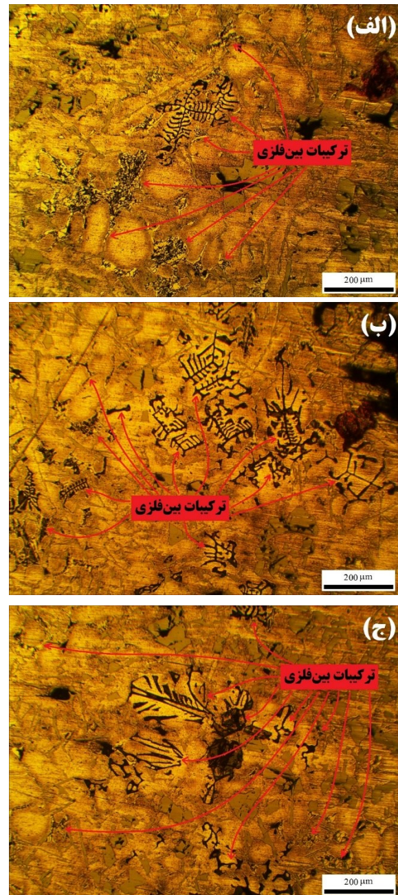
شکل ۲- تصاویر ترکیبات بین فلزی آلیاژ A390 ریختگی بعد از اچ کاری در بزرگنمایی ۱۰۰ برابر.
