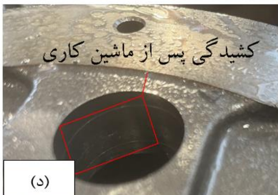
شکل ۴- تصاویر کشیدگی میکرو در شمش‌های تولید شده (الف) W1 (ب) W3 (ج) W4 و (د) W6
