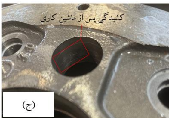
شکل ۴- تصاویر کشیدگی میکرو در شمش‌های تولید شده (الف) W1 (ب) W3 (ج) W4 و (د) W6
