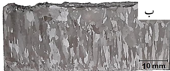
شکل ۵- ساختار ماکروسکوپی نمونه آلومینیوم خالص ریخته شده با دستگاه گریز از مرکز، (الف) بدون ورق آزیست و (ب) با ورق آزیست.
