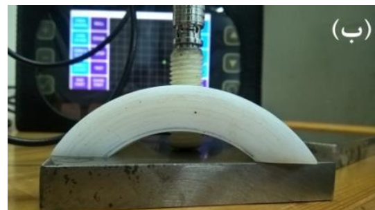
شکل ۲- تجهیزات بازرسی غیرمخرب: الف) دستگاه جریان گردابی مدل IH-ECP103، ب) تصویری از پراب و نگهدارنده آن روی بلوک فولادی.
