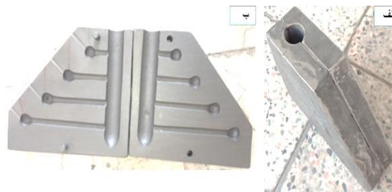
شکل ۳- قالب CRC برای اندازه‌گیری حساسیت به پارگی گرم: (الف) در حالت جفت شده، (ب) در حالت باز.
