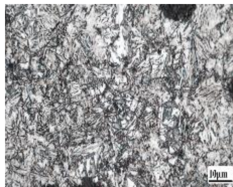
شکل ۵- تصاویر ریزساختار نمونه‌های آستنیت‌شده به مدت ۲ ساعت در دمای ۹۰۰°C و آستمیر شده در دمای ۴۵۰°C (الف) ۱ دقیقه، (ب) ۴ دقیقه، (ج) ۱۶ دقیقه، (د) ۳۲ دقیقه، (ه) ۶۴ دقیقه، (و) ۱۲۸ دقیقه، (ز) ۲۵۶ دقیقه، (ح) ۵۱۲ دقیقه. (آستنیت بلاکی=BRA، آستنیت غنی از کربن=γ HC ، فریت بینابینی=B α )
