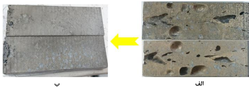
شکل ۴- تصاویر سطح نمونه‌ها، (الف) قبل از ریخته‌گری تحت فشار و (ب) بعد از ریخته‌گری تحت فشار
