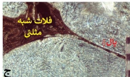
شکل ۵- نمایی از تصاویر اچ شده استریوگرافی از برش عرضی مقطع کامپوزیت زاماک ۵ با شبکه سه‌بعدی فوم مسی برای نمونه ریخته‌گری شده در ۴۵۰ سلسیوس.
