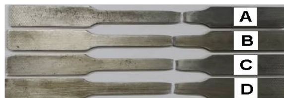
شکل ۶- نمونه‌های A تا D پس از انجام آزمایش کشش
