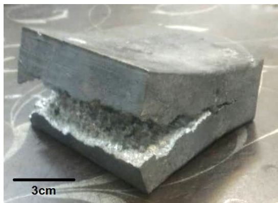
شکل ۷- ترک دهانه تمساحی که پس از نورد شمش بدون استفاده از پارامترهای بهینه نورد رخ داده است
