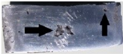
شکل ۵- الف) و ب) تصویر توزیع حرارتی حاصل از شبیه‌سازی شمش در دو زمان بارریزی متفاوت، ج) و د) تصویر تخلخل‌های احتمالی در حالت همراه با تغذیه و مبرد و بدون آن‌ها حاصل از شبیه‌سازی شمش. ه) و و): تصاویر برش خورده شمش همراه مبرد و تغذیه و بدون آن
