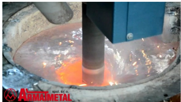
شکل ۱۰- تلاطم ایجاد شده در حین گاززدایی چرخشی مذاب آلومینیم [۵۰].
