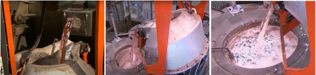
شکل ۸- تصویر مراحل انتقال مذاب در حین ریخته‌گری بلوک موتور خودروهای شرکت BMW [۴۶].
