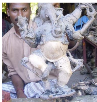
شکل ۲- ساخت یک مجسمه گانشا (شناخته شده‌ترین خدای فرقه‌های هندورا در دوران باستان) که به روش‌های کهن ریخته‌گری دقیق تولید شده است [۱۲].
