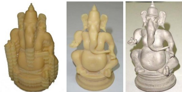
شکل ۹ - ساخت مدل گانشا با نمونه سازی سریع (الف) و سپس پرداخت مدل (ب) و در نهایت ریخته‌گری آن و ساخت مجسمه (ج) [۵۲].
