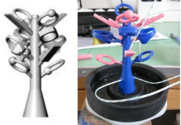
شکل ۱۴ - طراحی شماتیک یک درخت استاندارد با نرم‌افزار CAD (شکل سمت چپ) ساخت نمونه مومی آن به همراه سنسورهای دریافت دیتا در طی فرآیند (شکل سمت راست) [۸۸].
