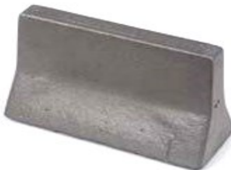
شکل ۲- تصویر وای‌بلوک ریخته شده مطابق با استاندارد DIN: 50125
