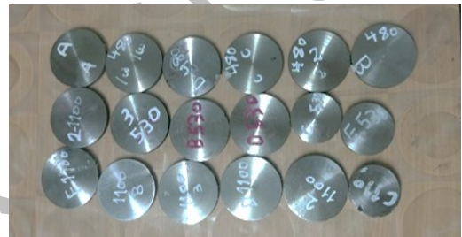
شکل ۴- نمونه‌های آزمایش سایش طبق استاندارد ASTM G99
