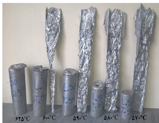
شکل ۵- مقایسه کسر جامد ایجاد شده بر روی سطح شیب‌دار در دماهای مختلف ذوب‌ریزی
