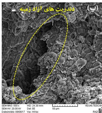
شکل ۸- تصاویر میکروسکوپ الکترونی روبشی از سطح شکست پارگی گرم آلیاژ 4Mn: (الف) حضور ترکیبات بین فلزی اولیه در سطح شکست میله D، (ب) تصویر با بزرگنمایی بالاتر از محل شکست گرم تصویر (۶-الف)، (پ) حضور دندریت های آزاد در سطح شکست پارگی گرم میله C.
