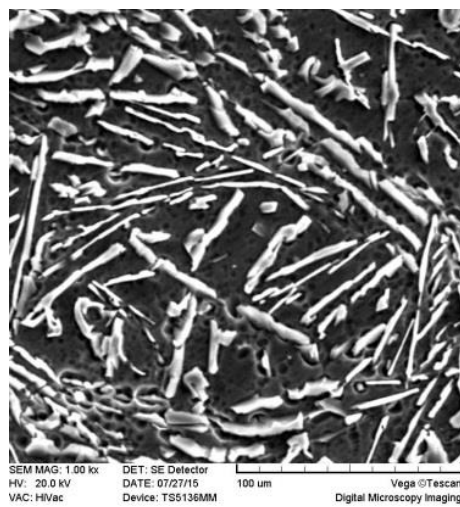
شکل ۵- ریزساختار SEM از یوتکتیک سوزنی لایه داخلی استوانه ریخته‌گی آلیاژ Al-11.9%Si
