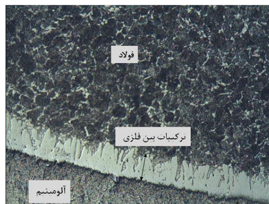
شکل ۵- تصویر میکروسکوپ نوری از نمونه‌ی غوطه‌ور شده در مذاب آلومینیم با دمای ۷۲۰ به مدت ۱۰ دقیقه.
