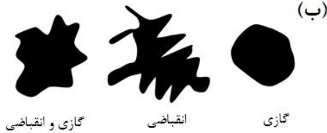
شکل ۱- (الف) تخلخل مشاهده شده روی سطح شکست آلیاژ A354. (ب) شکل و مورفولوژی سه نوع مختلف از تخلخل.
