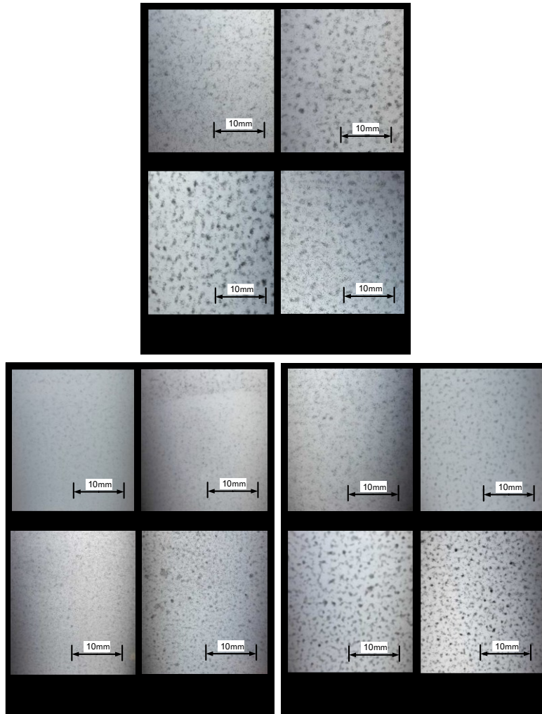
شکل ۸- تصاویر X-ray نمونه‌های آزمایش RPT سرریز برای آلیاژ A356 و مقادیر افزوده شده Be.
