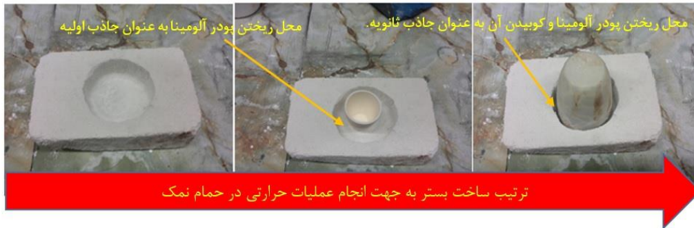
شکل ۱- مراحل ساخت و تصویر نهایی بستر برای استفاده در روش حمام نمک.
