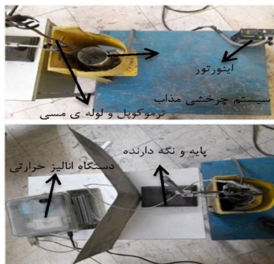
شکل ۲- نمای سیستم چرخشی و آنالیز حرارتی در فرآیند RCP
