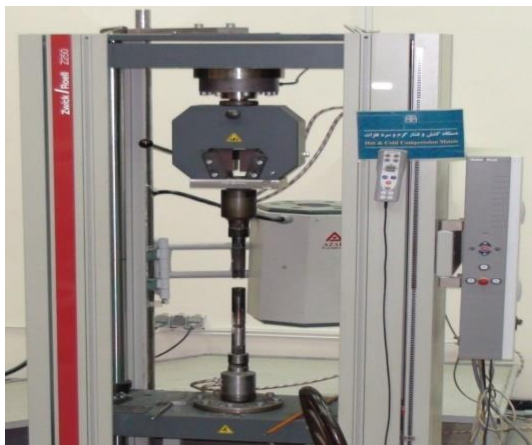
شکل ۱- دستگاه یونیورسال آزمون فشار مواد
