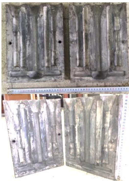
شکل ۲- قالب ریخته‌گری برای تولید کامپوزیت.
