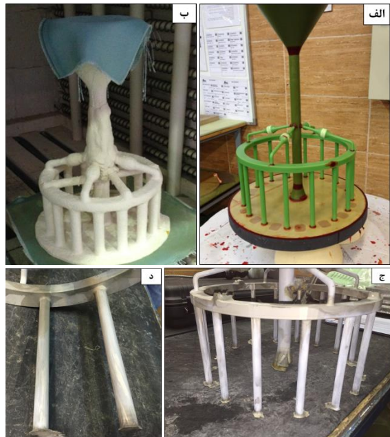
شکل ۱- مدل مومی ساخته شده برای ریخته‌گری جهت‌دار: (الف) قالب سرامیکی مورد استفاده برای ذوب‌ریزی، (ج) خوشه ۱۶ تایی ریخته‌گری شده، (د) ساختار جهت‌دار نمونه‌ها پس از ماکرو-اچ
