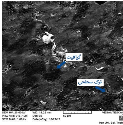
شکل ۸- تصاویر سطح سایش نمونه‌ی آستمبر شده تحت نیروی ۲۵ نیوتن (الف) تصویر الکترون برگشتی، (ب) تصویر الکترون ثانویه، (ج) آنالیز عنصری EDS
