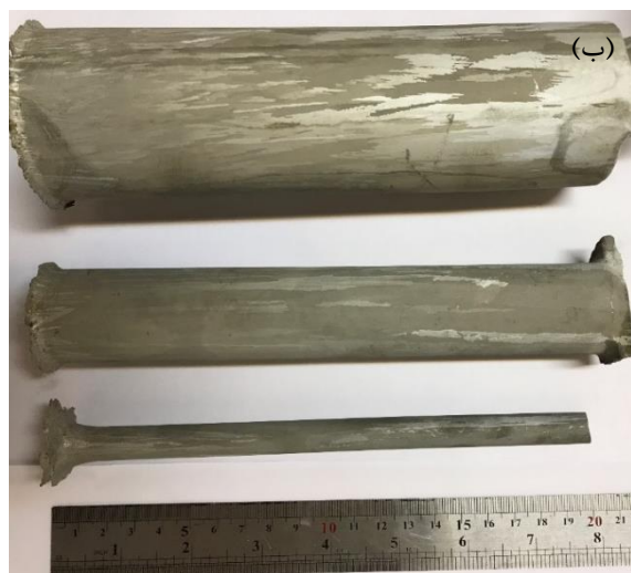
شکل ۲-الف- شمای دستگاه انجماد جهت‌دار استفاده شده و ب- نمونه‌های تولید شده به همراه درشت ساختار آنها.
