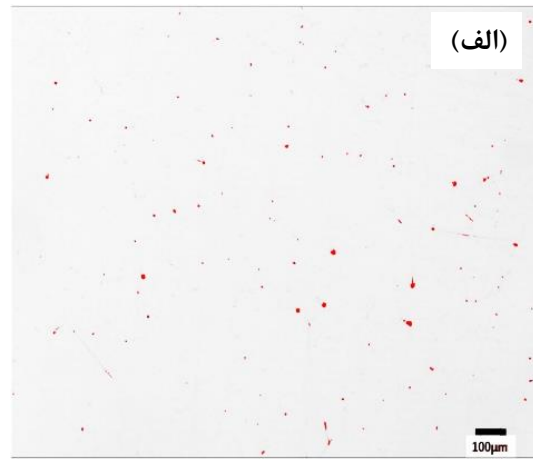
شکل ۴- تصویر میکروسکوپ نوری (الف) ساختار اچ نشده و (ب) ریزساختار ریختگی اچ شده از نمونه سوپرآلیاژ تک کریستال CMSX-4.
