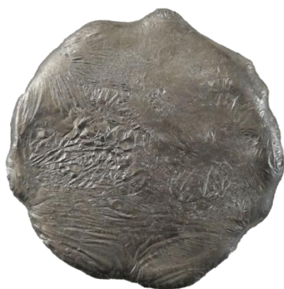
شکل ۴- آلیاژ آنتروپی بالای AlCoCrFeNi ساخته شده به روش (VAR)
