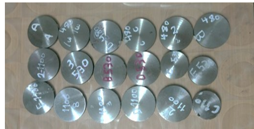
شکل ۴- نمونه‌های آزمایش سایش طبق استاندارد ASTM G99
