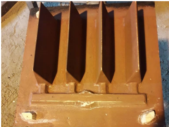
شکل ۲- مدل ریخته‌گری مورد استفاده برای قالب‌گیری
