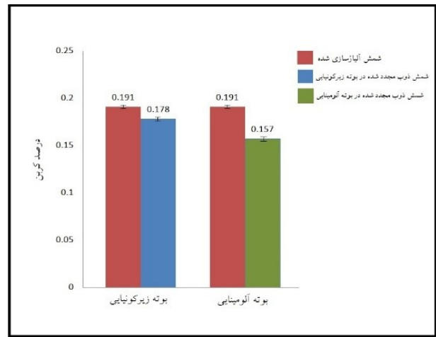
شکل ۱- اثر نوع بوته بر درصد وزنی کربن با زمان نگهداری مذاب در بوته به مدت ۳ دقیقه.
