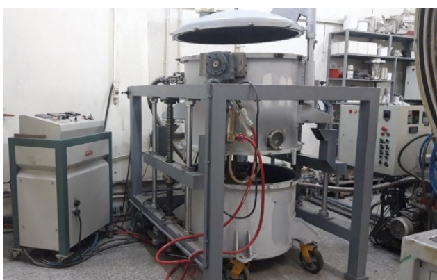
شکل ۱: کوره‌ی بریجمن مورد استفاده در این پژوهش.
