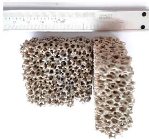
شکل ۲- تصویر استریو میکروسکوپ از پیش‌ماده سرامیکی از جنس آلومینا.
