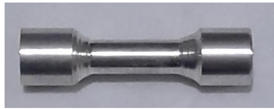
شکل ۳- نمونه کشش مورد استفاده جهت ارزیابی استحکام کششی.
