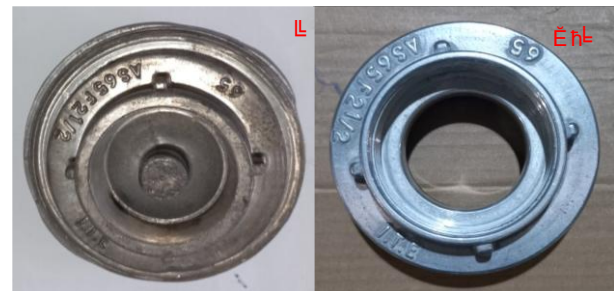
شکل ۶- قطعه استورز آلومینیم ۶۰۶۱، (الف) تولید شده به روش آهنگری و تراش خورده (نمونه شاهد) و (ب) تولید شده به روش ترکیبی ریخته‌گری و آهنگری
