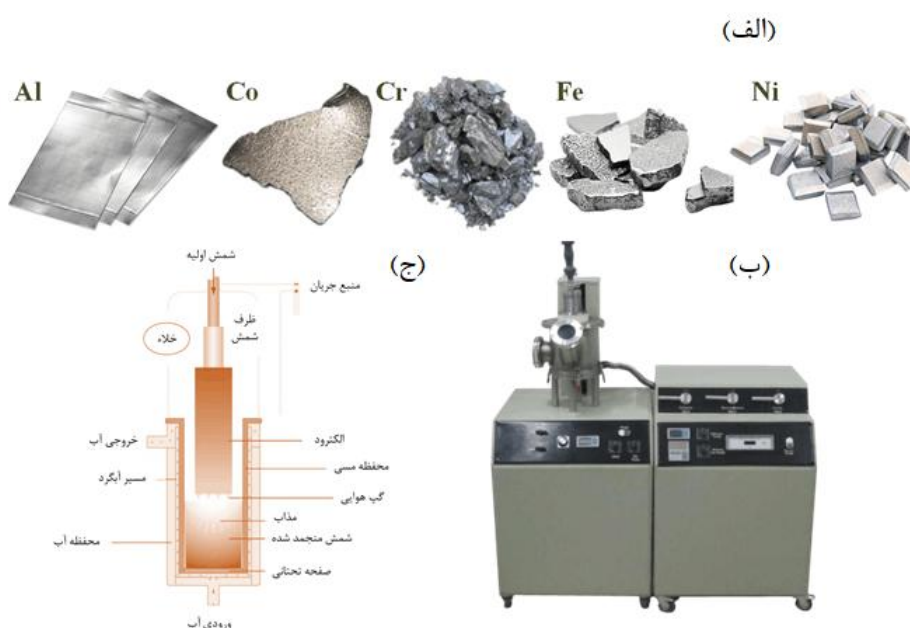
شکل ۳- مراحل آماده‌سازی آلیاژ آنتروپی بالا، (الف) مواد اولیه (آلومینیوم، کبالت، کروم، آهن و نیکل)، (ب) کوره ذوب قوسی در خلاء و (ج) شماتیک فرآیند ذوب مجدد قوسی در خلاء (VAR).
