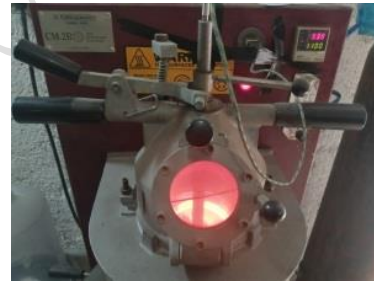
شکل ۲- تصاویر الف) تجهیزات فرآیند ریخته‌گری مکشی، ب) نمونه پیش ماده مسی با ضخامت دیواره ۱ میلی‌متر.
